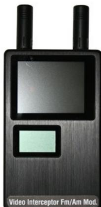
**Обнаружитель скрытых видеокамер с приемником "Interceptor"**
